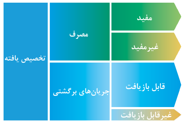
شکل ۴: تصویری از ابزار ردیابی آب برای بررسی تعاملات بین طرح های آبیاری با تمرکز بر جریان های برگشتی تحت انواع مختلف آبیاری.
